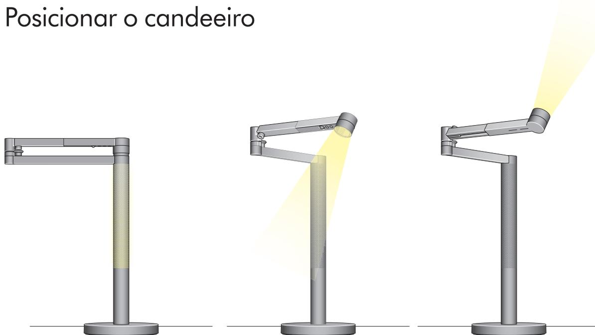
Pode alterar a posição da luz facilmente, rodando a cabeça ótica, o braço e/ou a haste até 360°.
