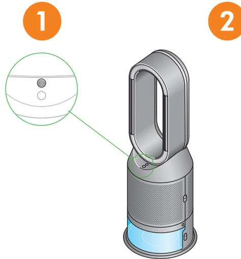
Pressione o botão do Ciclo de limpeza profunda na frente do aparelho para que as instruções necessárias sejam exibidas no ecrã LCD.
