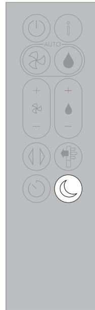
No Modo noturno, o seu ventilador humidificador purificante Dyson continuará a monitorizar e a responder às alterações de temperatura e de qualidade do ar, empregando apenas as configurações mais silenciosas e com a luminosidade do ecrã LCD diminuída.
