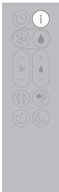
Pressione este botão para percorrer a informação monitorizada pelo seu ventilador humidificador purificante Dyson.
