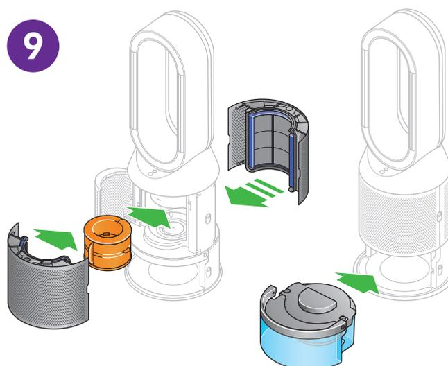
Volte a colocar o evaporador no interior do aparelho, assegurando-se de que fica corretamente encaixado.
