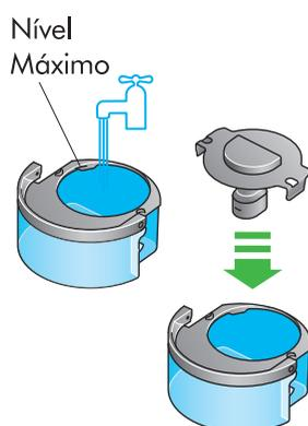
Volte a encher o depósito de água até ao nível máximo, secando qualquer excesso de água na exterior e recolocando a tampa, assegurando-se que os cliques que seguram a tampa estão bem fixos.
