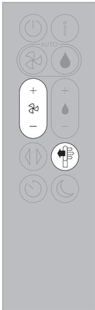
Pressione o botão da Velocidade do fluxo de ar para aumentar ou diminuir a velocidade do fluxo de ar.
