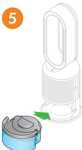
Coloque o depósito de água no interior do aparelho, deslizando até ouvir o clique que confirma que encaixou completamente.
