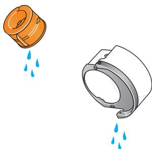
Liberte a tampa, remova o evaporador de dentro do depósito de água e passe-o por água fria da torneira.
