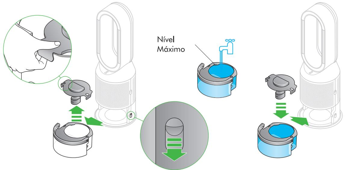
Antes de remover o depósito de água, assegure-se de que o modo de humificação está desligado e de que o depósito da água está vazio.
