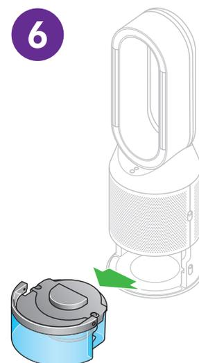
Quando o ecrã LCD mostrar que o Ciclo de limpeza profunda está completo, pressione os botões de segurança do depósito de água, de ambos os lados do aparelho, para o soltar.
