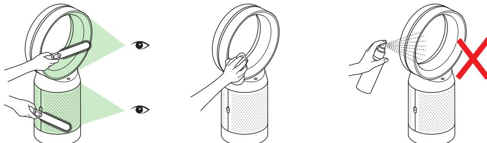
Procure obstruções nos orifícios das entradas de ar no filtro e na pequena abertura no interior do amplificador da circulação do ar.
